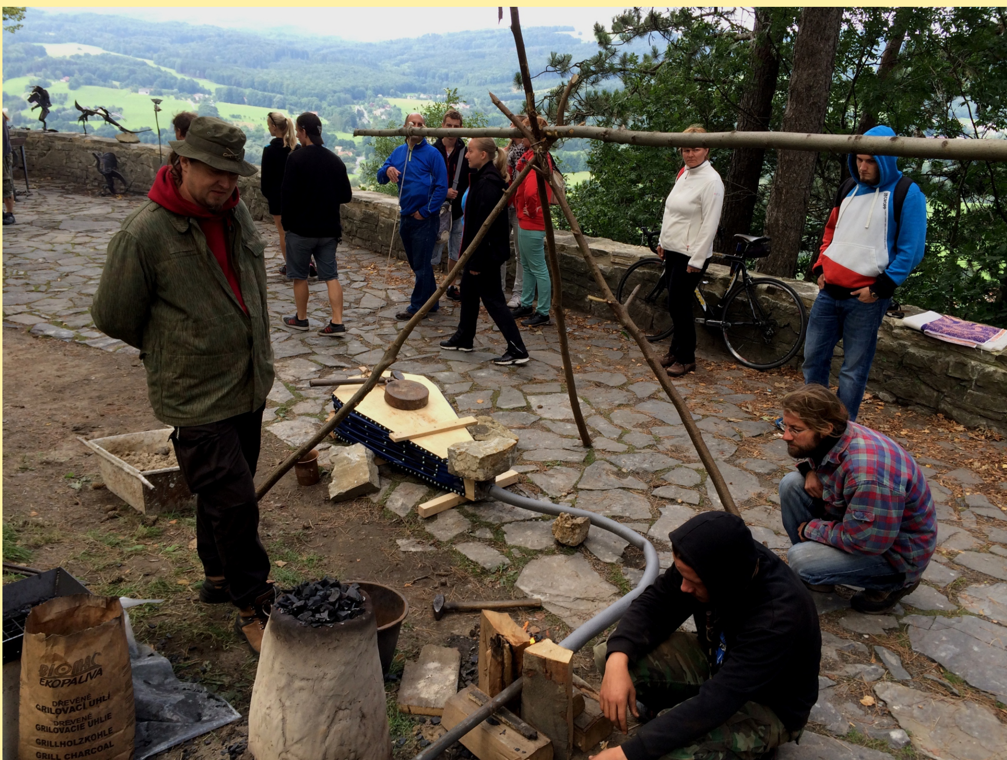
Experimentální tavba pelokarbonátů v replice pece z 9. století (zleva: vytavená houba, pec s měčem a vyjmutí vytavené houby. Experimental smelting of pelocarbonates in replica of 9th century furnace (from the left: smelted bloom; furnace with bellow and taking out of the freshly smelted bloom.
